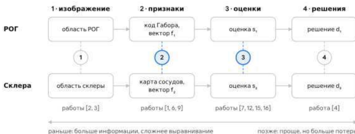
Рис. 1. Уровни слияния в гибридной системе «РОГ + склера» и примеры работ для каждого уровня (выделены уровни, используемые в предлагаемой системе)
